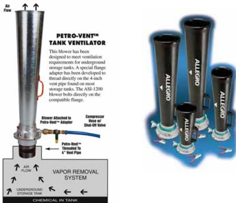
Fig. 26. Eiettori ad aria compressa, pensati per ambienti particolari. Si notino nell'immagine di destra le pinze per il collegamento equipotenziale ,contro i fenomeni elettrostatici. PRODUTTORE Allegro http://www.allegrosafety.com/
