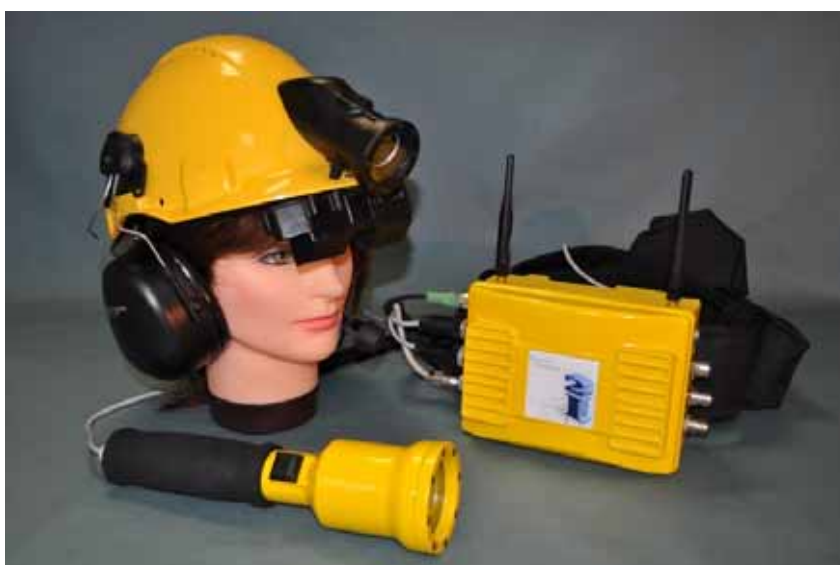
Fig. 27 Esempio di sistema di comunicazione bidirezionale audio e video che consente, ad esempio, di tenere in contatto l'operatore all'interno dell'ambiente confinato e un operatore esterno. L'immagine mostra un sistema dotato due sistemi di acquisizione di immagini, uno sul casco l'atro brandeggiabile con funzioni anche di torcia. Contemporaneamente il casco è dotato di un visore/schermo che permette in remoto di interagire in diretta con l'operatore su ciò che vede. Il tutto completato da un sistema audio di comunicazione PRODUTTORE I2 INDUSTRIAL INNOVATION PRODUTTORE http://www.industrial-innovation.it/
