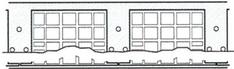
Figura 1 - Sezione tipo solaio laterocemento soggetto a sfondellamento
